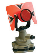
Bestell-Nr. 481 120-613 Prismenstation Typ Sokkia Dreifuß-Adapter mit optischem Lot. Genauigkeit: ± 2"
