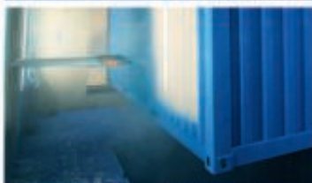
Lackierung mittels Pulverbeschichtung
